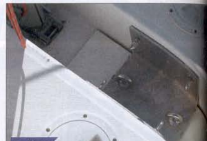
Pratique En ôtant cette plaque, on peut démonter facilement la quille.
